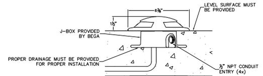
**77 070 wiring box - installation:**
